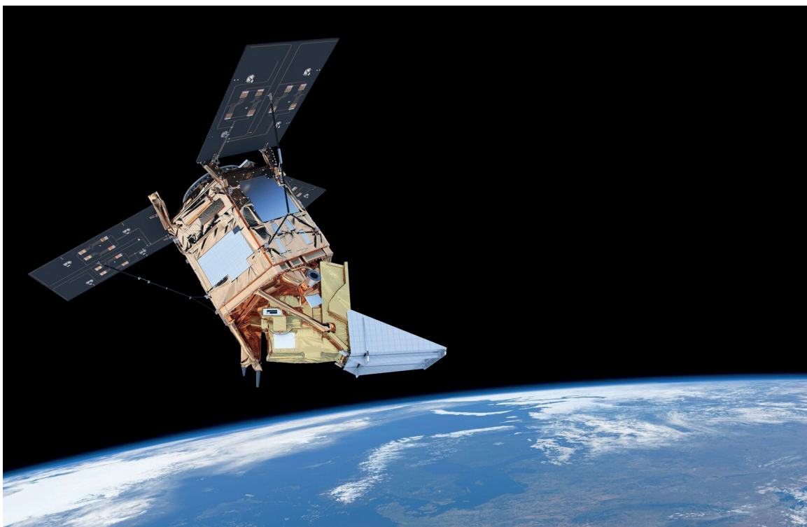
Afbeelding 1: Meetinstrument TROPOMI op de Sentinel 5P satelliet (ESA)
